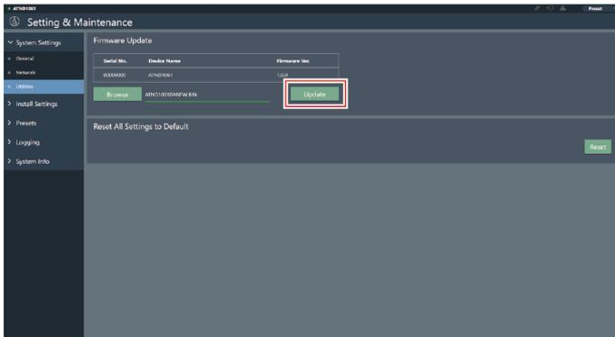
» 更新将开始。更新完成后，会显示已完成画面，话筒将自动重启。
