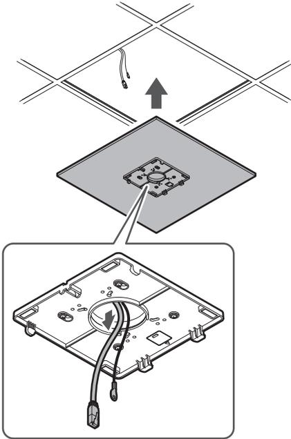
**8** 将桥板C调整到天花板框架的高度，并用螺钉（M4 × 10毫米）拧紧安装。
