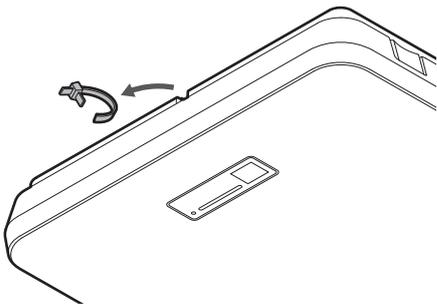
**2** 按下话筒上的释放按钮，从表面安装适配器上拆下话筒。
